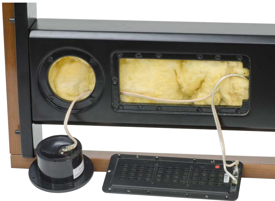
Rimossi i due trasduttori, notiamo come il volume interno sia rivestito di materiale assorbente dello stesso tipo di quello utilizzato per il woofer.
